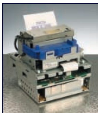
UP542 Version kiosque optimisée sans boîtier avec unité d'alimentation interne
