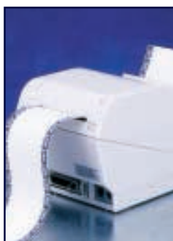
Chemin d'alimentation papier externe pour les applications de sécurité ou haute capacité
