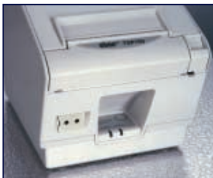
Protection du bouton d'alimentation pour empêcher les arrêts / démarrages intempestifs
