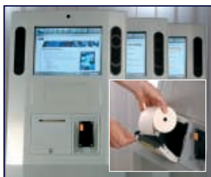
Imprimante kiosk avec sortie automatiquement réduite du format A4 en A6. (Pour plus de détails, voir la brochure Kiosque de Star)
