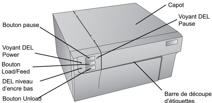
Le **bouton Pause** met l'imprimante en pause APRES l'impression en cours afin de permettre le chargement des étiquettes et des cartouches d'encre.
