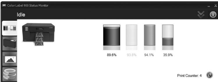
Dans le mode standard, les pourcentages d'encre seront affichés ainsi que les quatre onglets et le compteur d'impression. Les onglets ne peuvent s'ouvrir que si l'imprimante est inactive (pas d'impression en cours).
